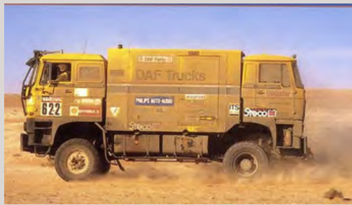
Un camión con dos motores uno delantero de 450CV y otro trasero de 420CV.
