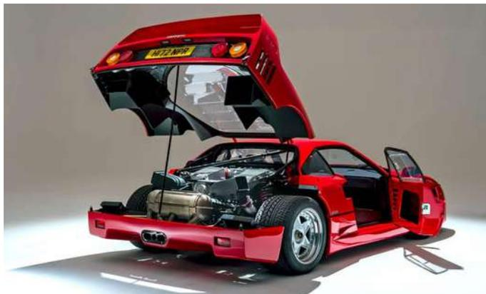
**Toda la estructura del F40 esta construida entre Kevlar y fibra de carbono.**
